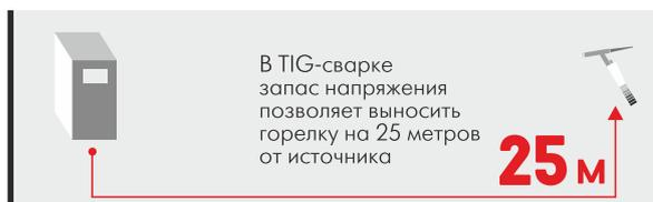
В TIG-сварке запас напряжения позволяет выносить горелку на 25 метров от источника
